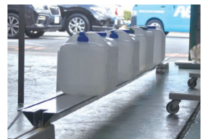
新システム「TERRA」は幅185mm、長さ4200mmのアルミ材で、架台のパネル受け材を一体化した構造を採用。試作とテストを重ねてきました。今回到着した試作品もまだまだバージョン・ゼロともいべき仕様ではありますが、今後実証試験とともにさらなる開発を進めて、次世代ソーラーシェアリングとしてふさわしいシステムへと熟成を重ねていく予定です。すでに国内特許は取得済み（特許第6960196号）で、アメリカ、中国など海外特許も申請中です。
